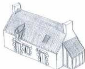
En appentis sur un pignon
