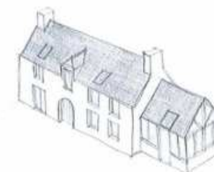
En pignon (toiture à 2 pentes symétriques)
